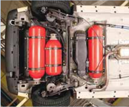
Unterflurtanks, Ventile, Leitungen und Regler sorgen für absolute Sicherheit
